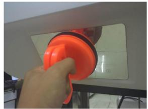
●用力将吸盘向后拉拔,即可拆下显示 组件
